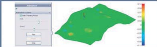
成形と厚さ変化を表示するアニメーション・プレイバック機能
